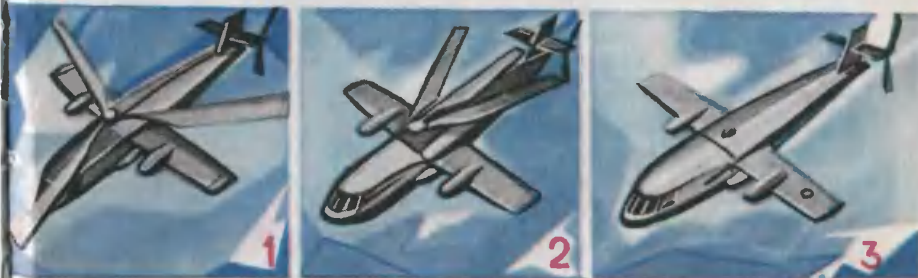
Две конструкции летательных аппаратов, сочетающие в себе преимущества вертолетов и самолетов.
